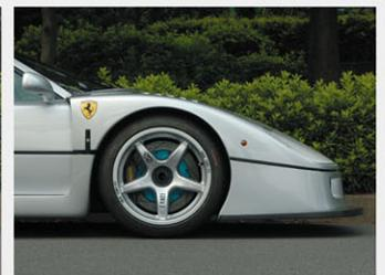
車高の切り替えを瞬時にを行います。(フロントスポイラー先端で40~45mmリフトアップ)
